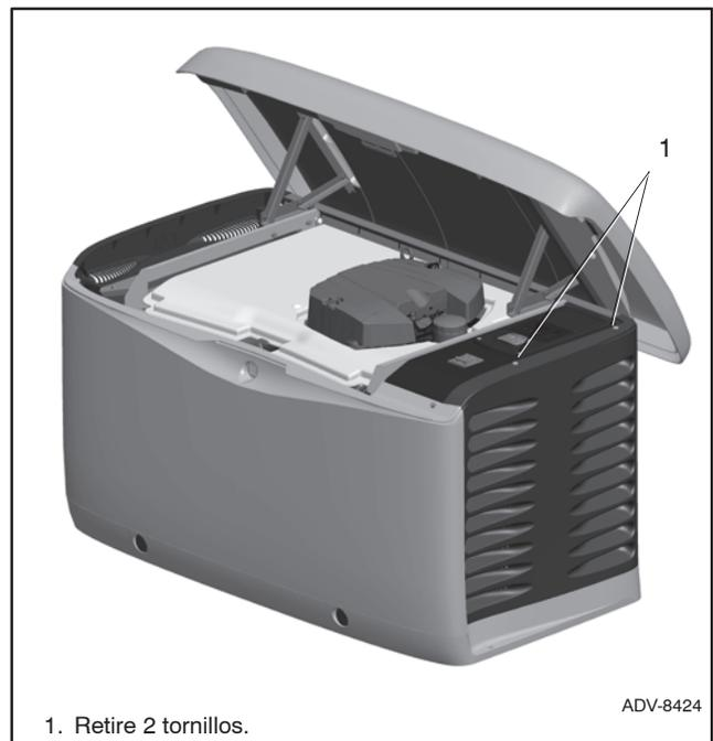
**Figura 1-4** Retiro del panel de admisión de aire
